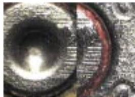
Spuren am Hülsenboden der Tatmunition (rechts) ähneln den Einkerbungen, die beim Abschuss von Vergleichsmunition mit einer am Tatort gefundenen Waffe zu sehen sind (links).
