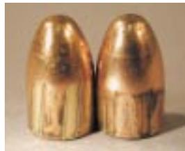
Zwei Kugeln mit je sechs rechtsdrehenden Feld- und Zugfurchen. Deren Neigungswinkel ist jedoch unterschiedlich, was darauf hindeutet, dass die Projektile aus unterschiedlichen Schusswaffen abgefeuert wurden.
