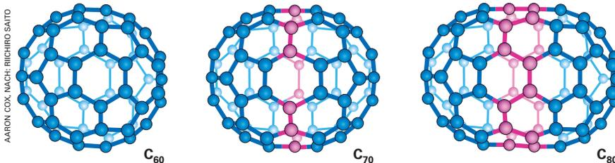
◀ In einem Fulleren sitzen Kohlenstoffatome an den Ecken eines Polyeders; dessen Kanten entsprechen den Bindungen zwischen den Atomen. Das klassische Buckminsterfulleren  $C_{60}$  entspricht dem Standardfußball; von  $C_{70}$  und  $C_{80}$  gibt es jeweils mehrere kombinatorische Möglichkeiten.
