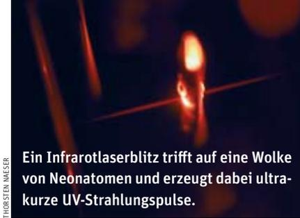
Ein Infrarotlaserblitz trifft auf eine Wolke von Neonatomen und erzeugt dabei ultrakurze UV-Strahlungspulse.
