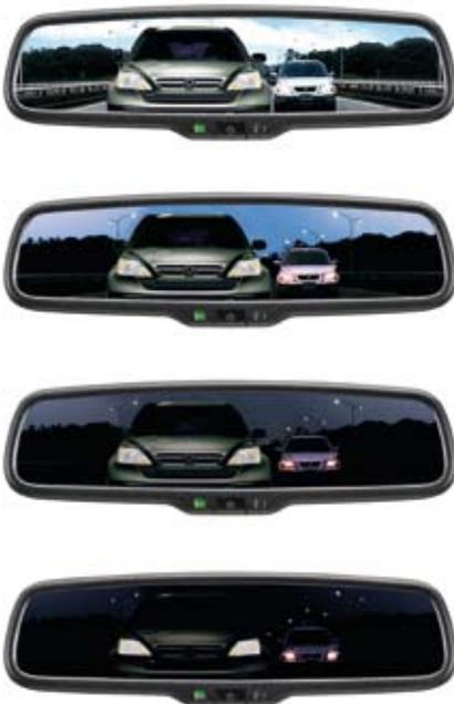
**Nie wieder blenden lassen: Rückspiegel mit elektrochromer Oberfläche, gesteuert durch lichtempfindliche Fotozellen, dunkeln ab, wenn das Scheinwerferlicht nachfolgender Fahrzeuge auf sie fällt.**
