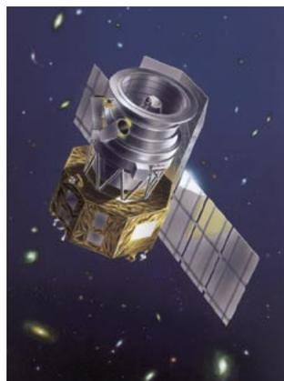
mit einer Brennweite von 4200 Millimetern. Der Hauptspiegel besteht aus goldbedampften Siliziumkarbid (SiC) und wiegt nur elf Kilogramm. Akari besitzt zwei Hauptinstrumente, den Far-Infrared Surveyor (FIS) und die Infrared Camera (IRC). Gemeinsam werden beide Instrumente den Infrarothimmel in 13 Kanälen abtasten. AKARI ist ein internationales Projekt, an dem neben der Europäischen Weltraumbehörde ESA die Länder Südkorea, Großbritannien und die Niederlande beteiligt sind. (ESA/JAXA)
