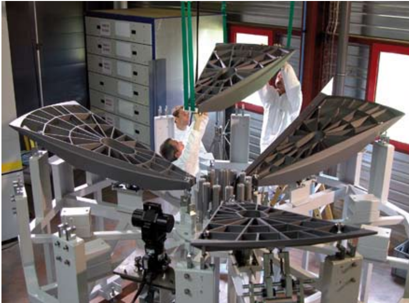
▲ Abb. 2: Der 3,5-m-Hauptspiegel wird aus Siliziumkarbid hergestellt und ist bei großer Steifigkeit und hoher optischer Qualität sehr leicht. Zwölf Sektorteile werden zu dem größten je für den Einsatz im Weltraum gebauten Spiegel zusammengesintert.
