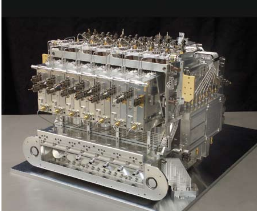
▲ Abb. 10: Das HIFI-Instrument deckt den Terahertz-Bereich mit sieben optimierten Empfänger-systemen ab.
