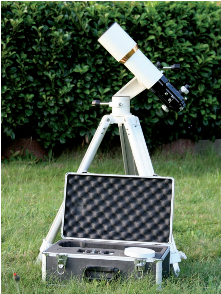
Das Teleskop montierte der Autor auf einer azimutalen Vixen Porta-Montierung.
