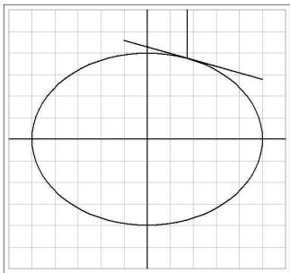
Die geographische Breite eines Ortes wird dadurch gemessen, dass man den Winkel zwischen der Tangentialebene der Erdoberfläche (also in Richtung des Horizonts) und der Verlängerung der Erdachse (ungefähr in Richtung des Polarsterns) misst (Abb. links). In
