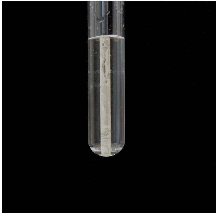
Abbildung 7: Silberabscheidung an der negativ polarisierten Superkondensator-Elektrode.
