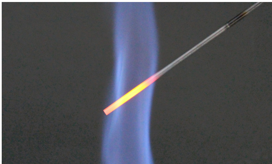
Abbildung 1: Ausglühen einer Bleistiftmine.
