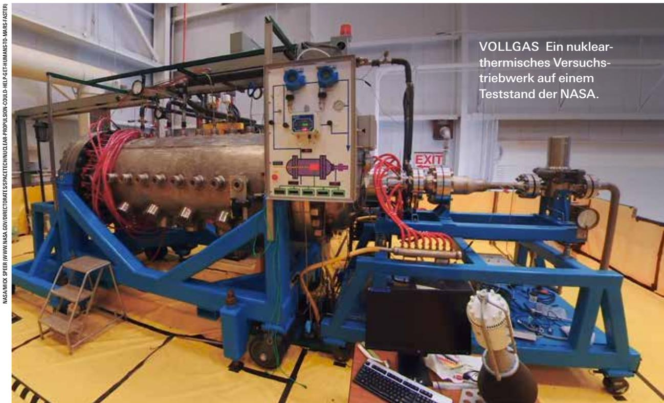
VOLLGAS Ein nuklearthermisches Versuchstriebwerk auf einem Teststand der NASA.
