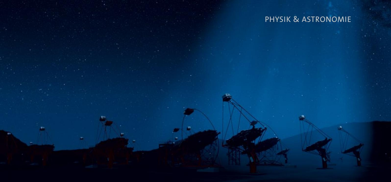
Die Teleskope des geplanten Cherenkov Telescope Array (CTA) sollen Dunkle Materie indirekt nachweisen. Sie registrieren, wenn energiereiche Photonen, die bei der Zerstrahlung von Dunkle-Materie-Teilchen erzeugt wurden, auf die Erdatmosphäre prallen.
