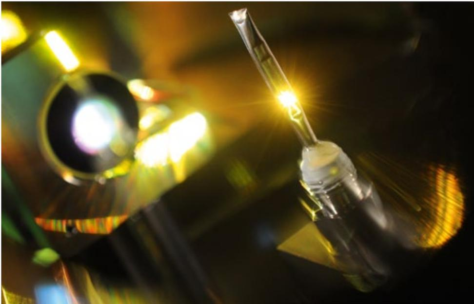
Durch ein Röhrchen lassen Forscher im Max-Planck-Institut für Quantenoptik Edelgas in eine Experimentierkammer strömen, auf das sie intensive Pulse aus Laserlicht schießen. So regen sie die Atome im Gas an und erzeugen unsichtbare Röntgenblitze. Diese sind derart kurz, dass die Physiker mit ihnen sogar die Bewegungen von Elektronen in Atomen, Molekülen oder Festkörpern untersuchen können.
