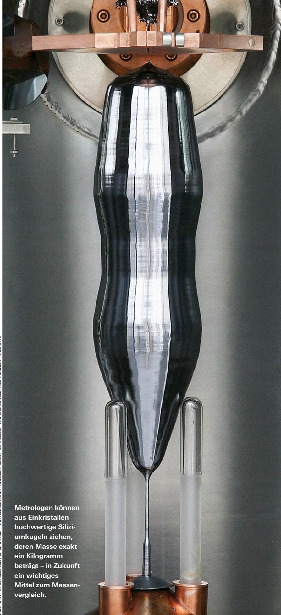
**Metrologen können aus Einkristallen hochwertige Siliziumkugeln ziehen, deren Masse exakt ein Kilogramm beträgt – in Zukunft ein wichtiges Mittel zum Massenvergleich.**
