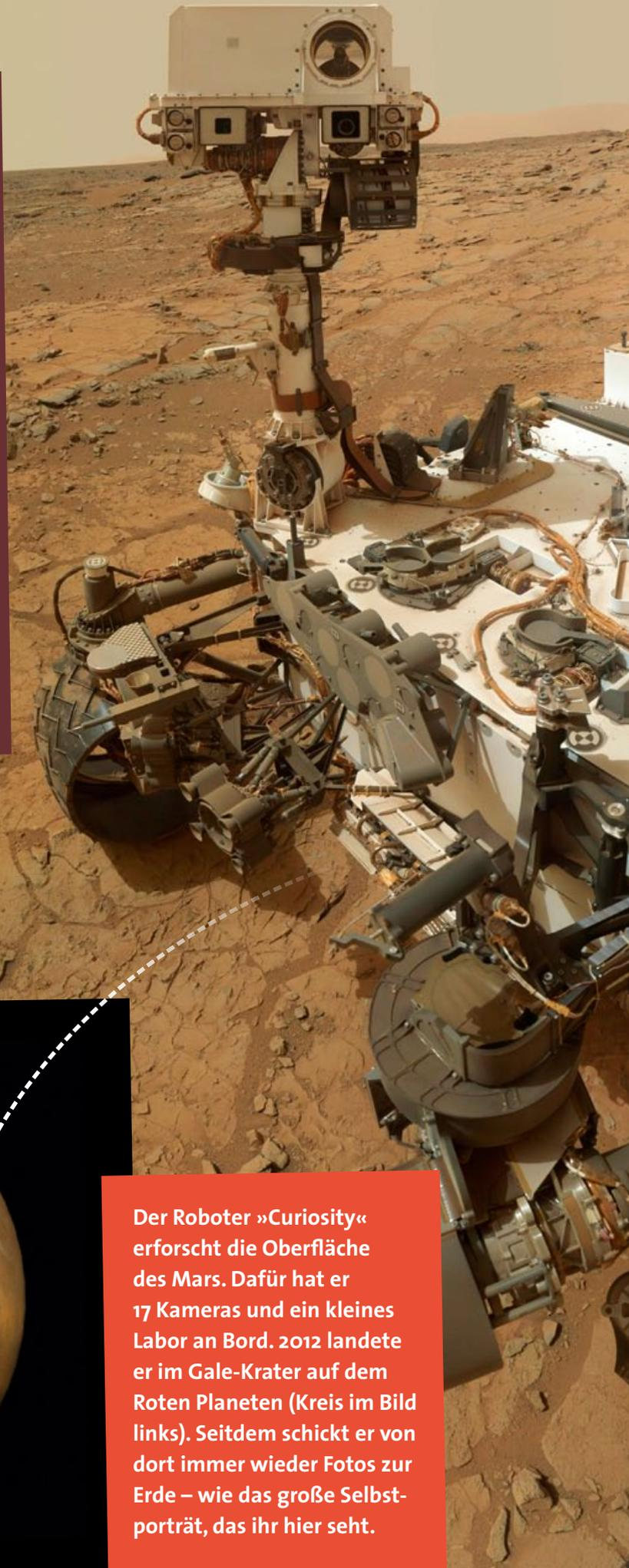
Der Roboter »Curiosity« erforscht die Oberfläche des Mars. Dafür hat er 17 Kameras und ein kleines Labor an Bord. 2012 landete er im Gale-Krater auf dem Roten Planeten (Kreis im Bild links). Seitdem schickt er von dort immer wieder Fotos zur Erde – wie das große Selbstporträt, das ihr hier seht.
