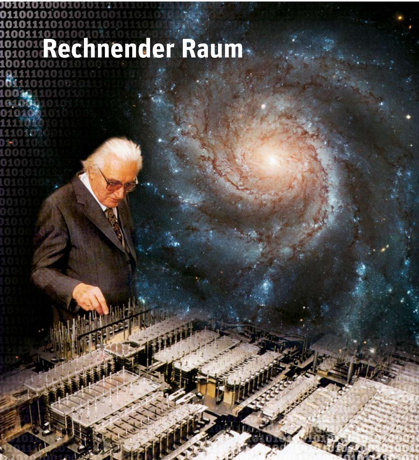
Der mechanische Rechner Z1, den Konrad Zuse mit fast 80 Jahren aus dem Gedächtnis nachbaute, kann schwerlich als Modell für das rechnende Universum gelten. Aber Zuse gelang es, weit über die Fähigkeiten seines Geräts – und heutiger Supercomputer – hinauszudenken.
