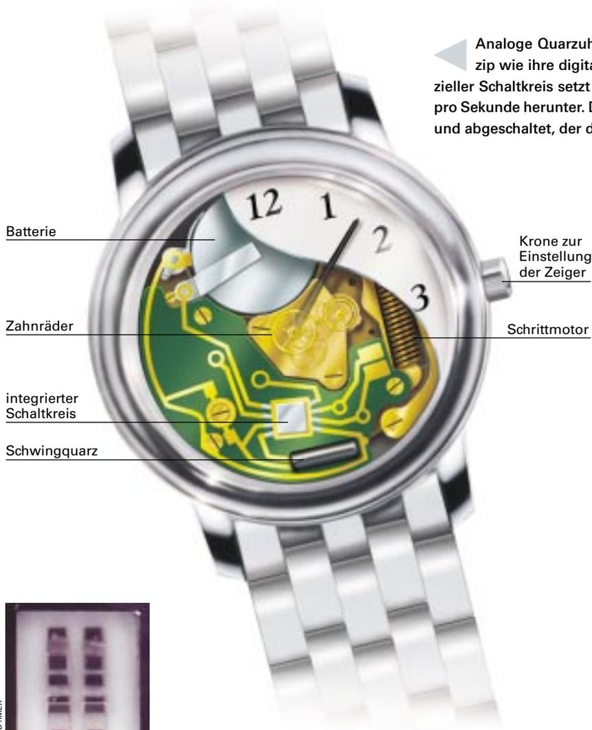
◀ Analoge Quarzuhren verwenden dasselbe Prinzip wie ihre digitalen Verwandten, doch ein spezieller Schaltkreis setzt die Schwingungszahl auf zwei pro Sekunde herunter. Damit wird ein Schrittmotor an- und abgeschaltet, der den Sekundenzeiger betätigt.
