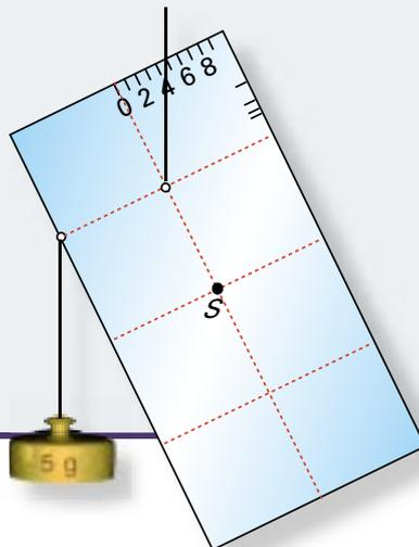
▷ Streng genommen ist diese Waage nur nahe der Position mit waagerechten und senkrechten Stangen indifferent, aber die Fehler sind sehr klein.
