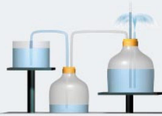
▷ weit unten abschneidet, spritzt das Wasser nach oben heraus. Auf Herons Brunnen angewandt: In einem längeren Röhren an der Stelle des Spritzröhrens (das im Bild rechts oben nur zur Erläuterung eingezeichnet ist) muss im Gleichgewicht der Niveauunterschied zwischen den »linken« Wasserspiegeln so groß sein wie zwischen den »rechten«. Da das rechte Röhren aber in Wirklichkeit zu kurz ist, spritzt dort das Wasser heraus.
