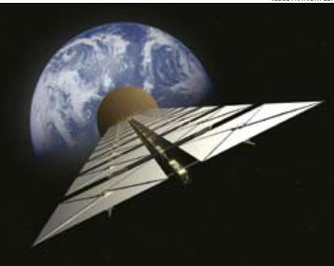
Vor allem leicht soll es werden. Das Sonnensegel, mit dessen Hilfe eine Sonde die Grenzen des Sonnensystems überschreiten könnte, dürfte maximal rund ein Gramm pro Quadratmeter wiegen – einschließlich der tragenden Streben. Gegenwärtig sind 20 Gramm erreichbar.
