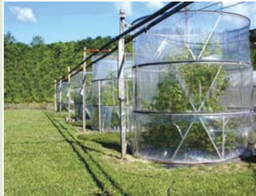
Solche oben offenen Kammern bieten Setzlingen und jungen Bäumen das ganze Jahr über kontrolliert wärmere Bedingungen.
