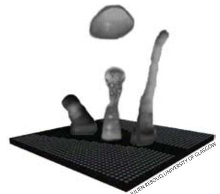
**Dank der 160 Mikrometer breiten Löcher an den Seiten der Platte lassen die Schallwellen Wassersäulen je nach lokaler Geometrie in verschiedene Richtungen aufsteigen.**
