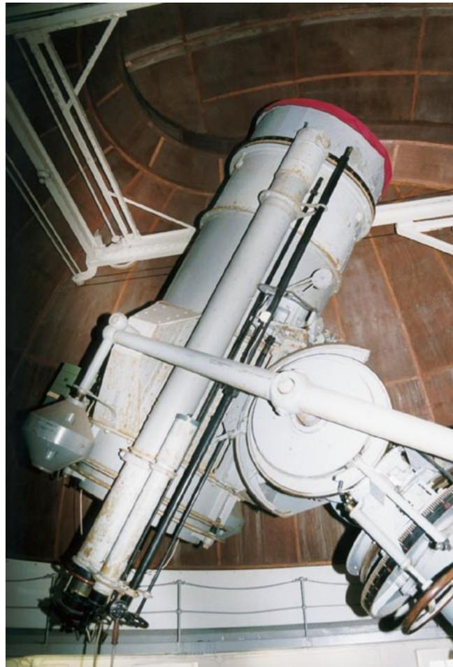
▲ Abb. 5: Auf der hohlen Stundenachse des Refraktors sitzt das Schneckenrad mit 1.2 m Durchmesser, das früher durch ein Uhrwerk angetrieben wurde.
