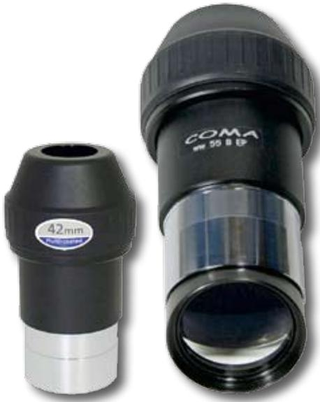
Das vom Karlsruher Teleskopladen angebotene Coma 55 B EP (rechts) besitzt eine vorgeschaltete abschraubbare Linsengruppe. Das eigentliche Okular entspricht dem links kleiner dargestellten APEX-Okular mit 42 Millimeter Brennweite.
