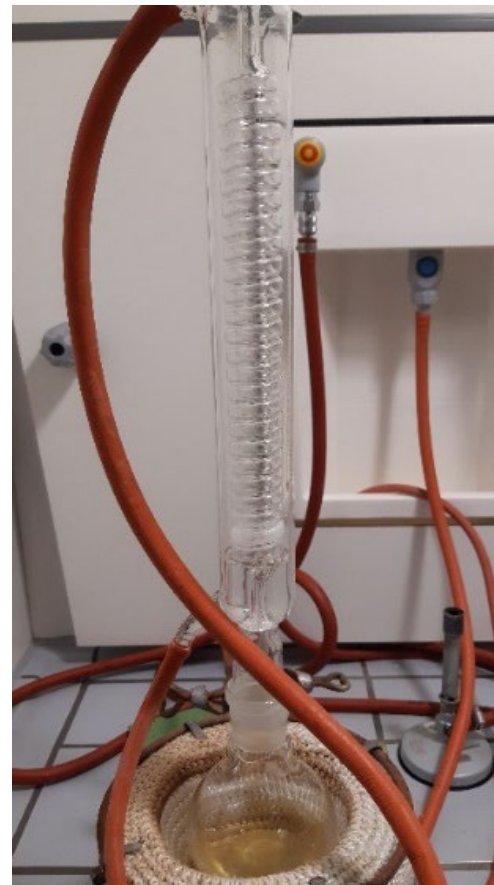
Abbildung 11: Links. Das Ergebnis des ersten Versuchsteils des Experiments zur simulierten Europa-Chemie nach 6 Tagen. Rechts: Die für den zweiten Versuchsteil verwendete Destillationsapparatur. ©: Polina Terenteva.
