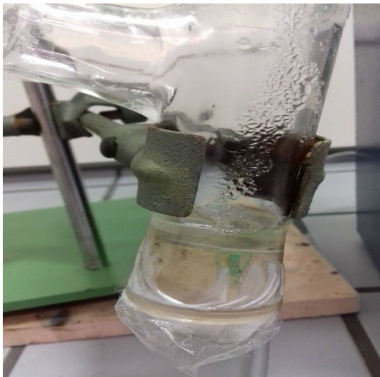
Abbildung 5: Links: Das Reaktionsprodukt des Miller-Urey-Experiments im Chemieraum, eine leicht grünlich aussehende Flüssigkeit, wird nach Kondensation im Teil 5 des Versuchs (siehe Abb. 4) aufgefangen. Rechts: Zur besseren Betrachtung wurde das Reaktionsprodukt in einen Erlenmeyer-Kolben gegeben. ©: Polina
