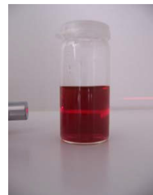
Abb. 22 : Tyndall-Effekt bei Gold-Nanopartikeln (eigene Quelle)
