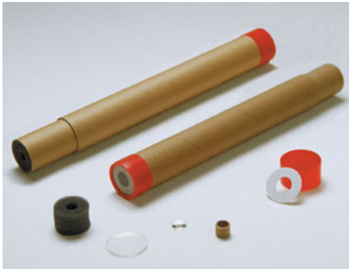
Abbildung 4: Nachbau eines Galileischen Fernrohrs. Gebraucht werden zwei ineinander verschiebbare Papprohre, zwei Linsen sowie Ringe und Hülsen zur Befestigung dieser.
