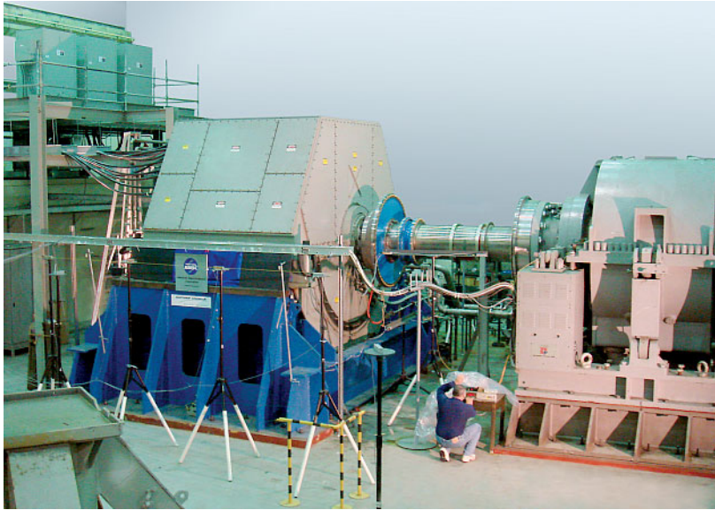
Abb. 5 Prototyp eines Schiffsmotors von American Superconductor mit 36,5 MW elektrischer Leistung. Seine Spulen bestehen aus einem Hochtemperatursupraleiter und verkräften eine 150-mal höhere Stromdichte als konventionelle Supraleiter. Der Wirkungsgrad solcher Motoren übersteigt denjenigen konventioneller Elektromotoren zwar kaum. Sie sind aber wesentlich kompakter, was in Schiffen wertvollen Platz spart. Zudem ist ihr Drehmoment wesentlich höher (Foto: American Superconductor).
