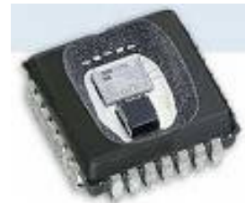
Beschleunigungssensor mit Piezokristall
