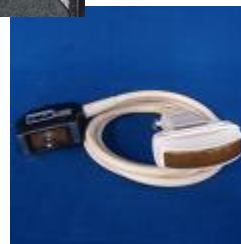
Beschleunigungssensor mit Piezokristall
