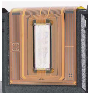
Beschleunigungssensor mit Piezokristall
