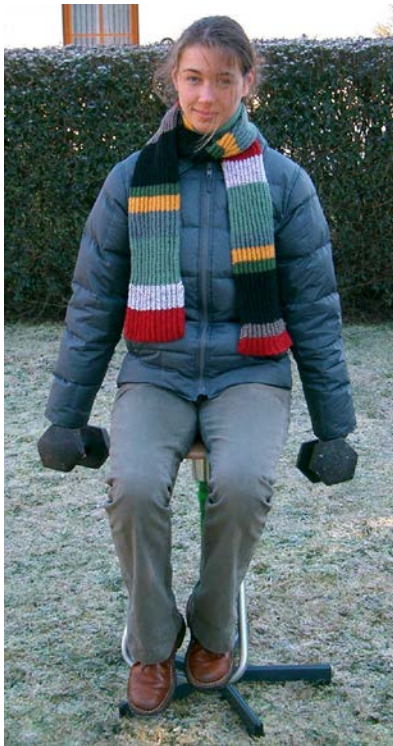
Abbildung 2: Drehstuhlversuch (links) und Freihandversuch (rechts) zur Demonstration der Drehimpulserhaltung (Bild rechts abrufbar unter: DRALL.JPG ). Zum Drehstuhlversuch kann unter drehstuhl.avi ein Videoclip abgerufen werden.
