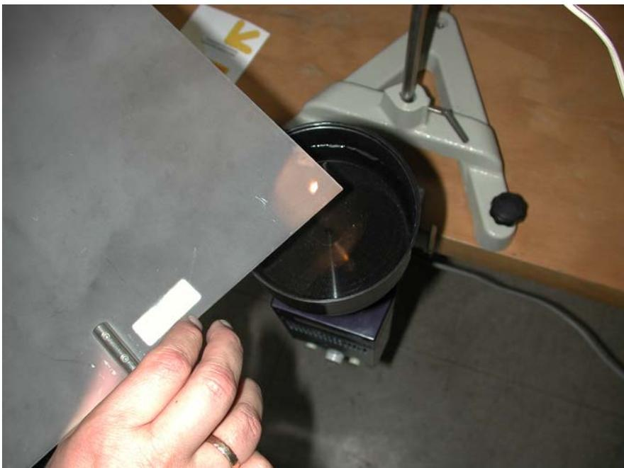
**Abbildung 5:** Brennpunkt des durch die rotierende Flüssigkeitsoberfläche gesammelten Lichts.
