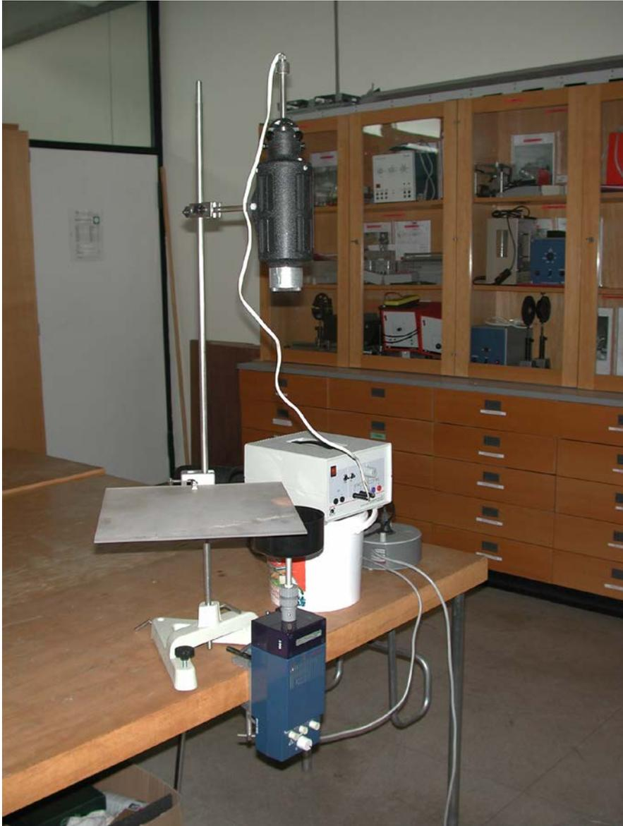
**Abbildung 4:** Versuchsaufbau zur Erzeugung einer rotierenden Flüssigkeitsoberfläche.
