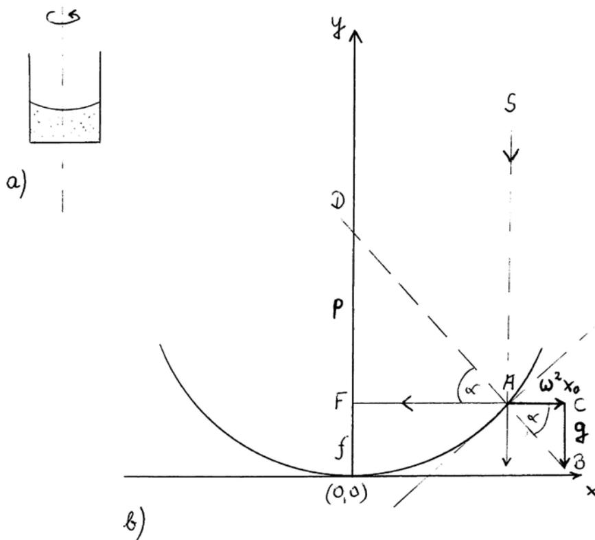
**Abbildung 3:** Krümmung einer rotierenden Flüssigkeitsoberfläche und die dabei wirkenden Beschleunigungen.
