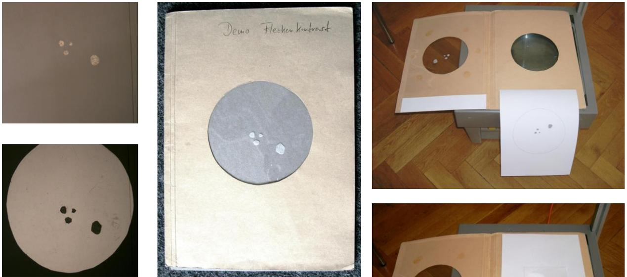
**Abbildung 6:** Für den Versuch werden benötigt: ein alter Schnellhefter mit einem Kreisausschnitt in der Mitte, ein Bogen Zeichenkarton, eine Folie, etwas Transparentpapier und ein Overheadprojektor.
