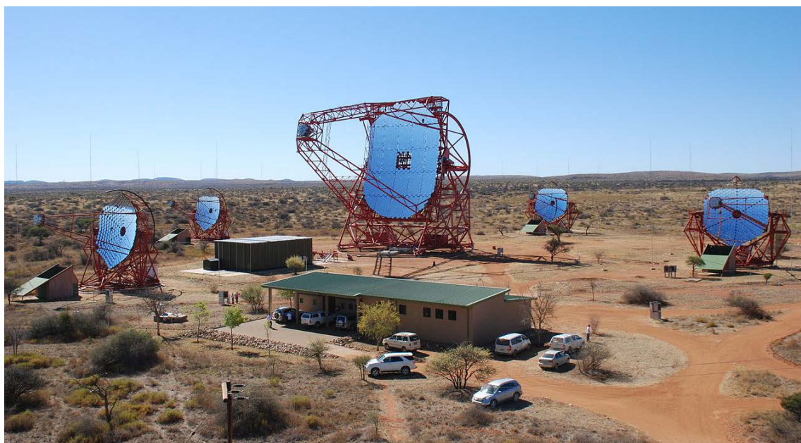
Vier 13-m-Schüsseln und eine 28-m-Schüssel bilden das Teleskopsystem H. E. S. S. II zum indirekten Nachweis sehr hochenergetischer Kosmischer Gammastrahlung. ©: Von Christian99 - Eigenes Werk, CC BY-SA 3.0, https://commons.wikimedia.org/w/index.php?curid=21999706 , https://upload.wikimedia.org/wikipedia/commons/f/f3/H.E.S.S. II Telescope Array.jpg .
