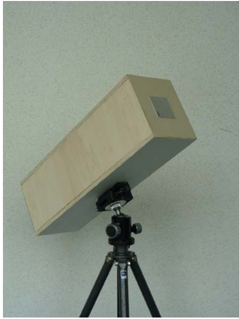
Abbildung links: Lochkamera - Selbstbau Abbildung rechts: Sonnenbild auf dem transparenten Schirm
