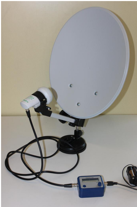
Abbildung 9: Fertiger Aufbau des Radioteleskopmodells mit Camping-Sat-Anlage, Satellitenfinder und Spannungsquelle.
