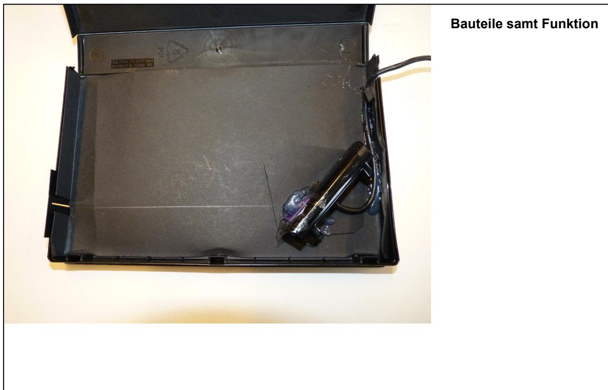
Abbildung: Innenaufbau des Videospektroskops. Vor dem Webcam-Objektiv befindet sich ein Transmissionsgitter, das aus einem Stück einer CD besteht.
