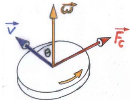
**Abbildung 5:** Zur Definition der Corioliskraft.
