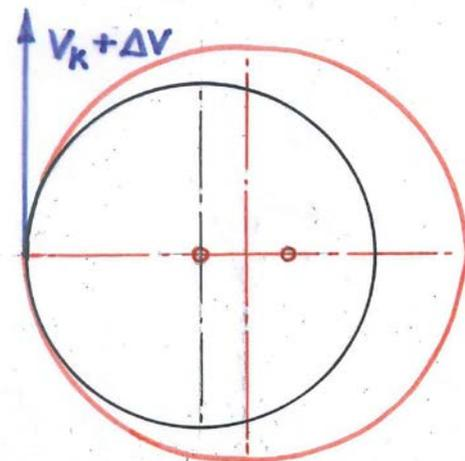
**Abbildung 9:** Nach einem Absprung in Flugrichtung nach vorn beschreibt der Raumfahrer eine Bahnellipse, deren große Achse den Durchmesser der Kreisbahn übertrifft. Der Raumfahrer benötigt daher mehr Zeit für einen Umlauf.
