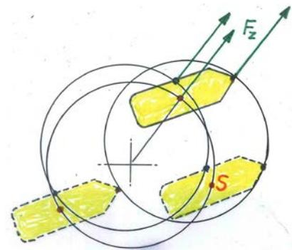
**Abbildung 1:** Wird der Schwerpunkt  $S$  eines ausgedehnten Körpers auf einem Kreis herumgeführt, während der Körper zu sich selbst parallel bleibt, beschreiben alle seine Punkte deckungsgleiche Kreise.
