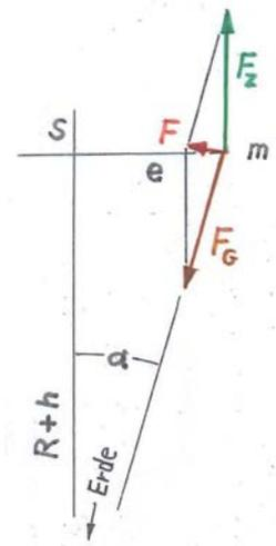
Abbildung 3: Eine Masse  $m$ , die in derselben Horizontalebene wie der Schwerpunkt S liegt, erfährt eine rücktreibende Kraft  $F$ , die mit dem Abstand  $e$  zwischen  $m$  und S anwächst (und zwar direkt proportional, sofern  $e$  nicht zu groß ist).
