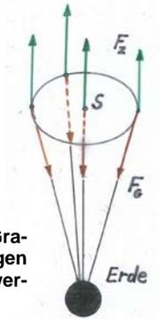
Abbildung 2: Zentrifugalkraft  $F_Z$  und Gravitationskraft  $F_G$  können sich wegen Richtungsabweichung nur im Schwerpunkt S exakt aufheben.
