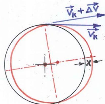
Abbildung 8: Stößt sich der Raumfahrer in Richtung der Hochachse vom Raumschiff ab, beschreibt er eine Ellipsenbahn (rot) mit gleicher Umlaufzeit (große Halbachse gleich Kreisbahnradius).
