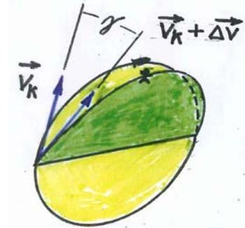
**Abbildung 4:** Stößt sich der Raumfahrer genau in Richtung der Querachse vom Raumschiff ab, bewegen sich beide auf zueinander gekippten Kreisbahnen gleicher Größe (Kippwinkel  $\gamma$ ).
