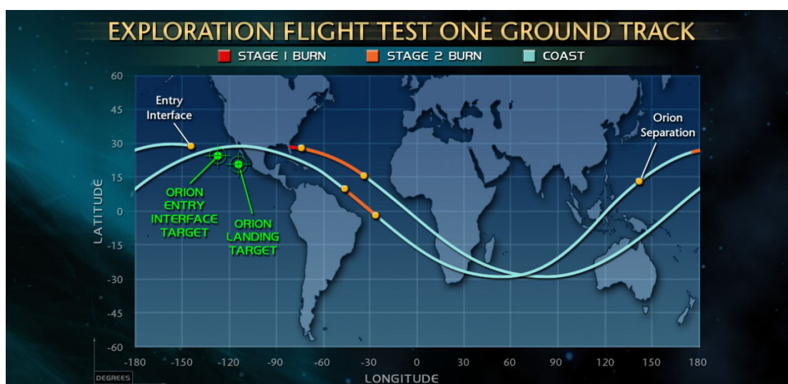
Ground track des EFT-1 Flugs der Orion Kapsel. Von Cape Canaveral aus umkreiste die Kapsel auf einer erdnahen Umlaufbahn einmal die Erde, um nach dem erneuten Zünden der zweiten Stufe in eine sehr exzentrische Umlaufbahn einzuschwenken und nahe der Halbinsel Baja California zu wassern. (Abb.: NASA)
