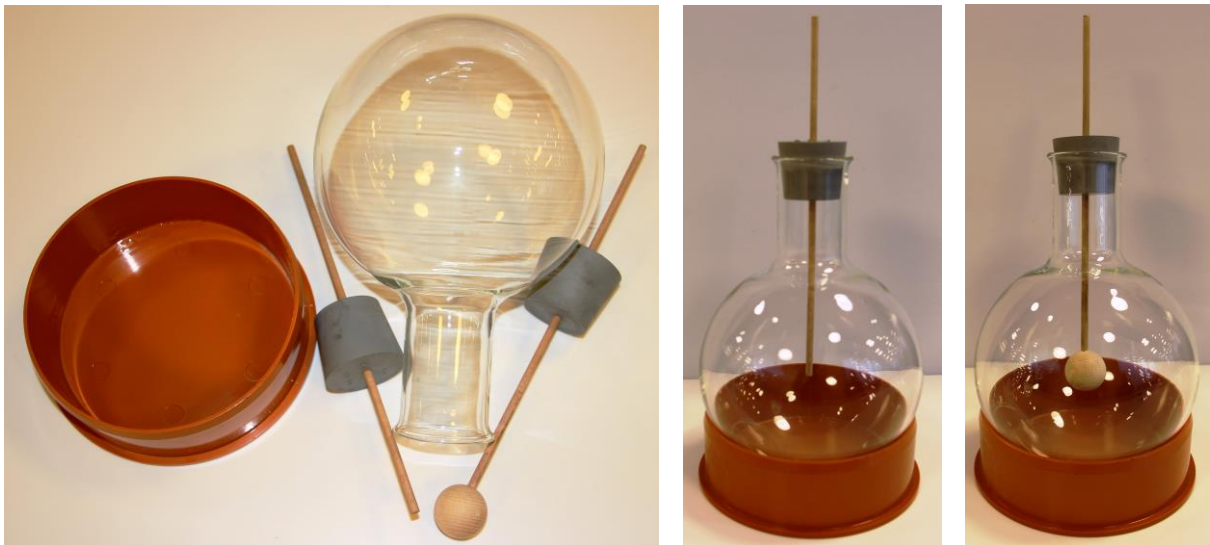
Abbildung 3: Bestandteile des Flaschenglobus: Enghalsrundkolben, mittig durchbohrter Stopfen mit Rundstab, Abstellring. Zusätzlich hilfreich: Rundstab mit Kugel zum Zeigen der Erde im Zentrum der scheinbaren Himmelskugel. ©: Olaf Fischer.
