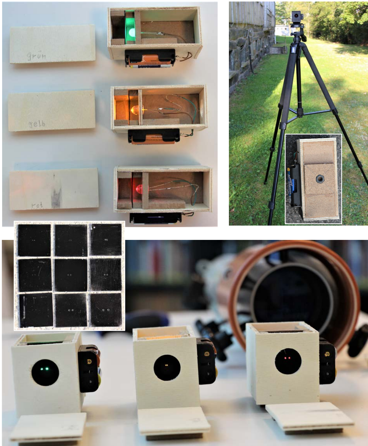
Abbildung 17: Oben links: Blicke ins Innere der Modell-Doppelsternboxen, die aus MDF-Plattenmaterial und Sperrholz hergestellt wurden. Oben rechts: In die Unterseite der Modell-Doppelsterne wurde eine Mutter mit Fotogewinde (1/4") eingelassen, um die Box auf ein Stativ schrauben zu können. Unten: Modell-Doppelsterne für die Farben grün, gelb und rot mit verschiedenen Doppellochblenden zur Realisierung verschiedener Doppelstern-Winkelabstände und Sternhelligkeiten. ©: O. Fischer / HdA.
