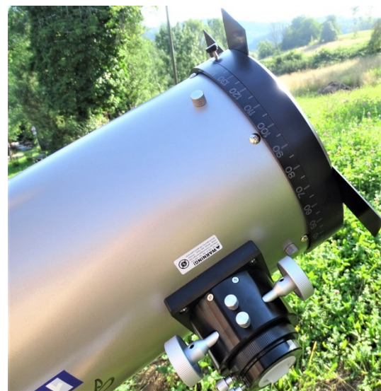
Abbildung 29: Interferometer-Vorsatz für eine 20-cm-Dobson-Fernrohröffnung am Fernrohr und in Einzelteilen. ©: Philipp Greiner.
