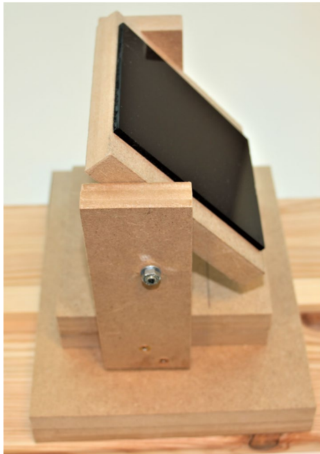
Abbildung 6: Reflektor-Einheiten des Selbstbau-Fettfleckfotometers auf der Schiebeschiene. Als Reflektoren werden hier Schweißglasplatten genutzt, weil diese im Gegensatz zu Spiegeln einen deutlich geringeren Reflexionsgrad (der zur Reduzierung der Strahlstärke der Sonne benötigt wird) haben. Links: Drehbarer Reflektor zum „Einfangen“ des Sonnenlichts (siehe auch Abb. 7). Die Trägerplatte des Reflektors wurde mittels Stuhlwinkeln mit den zwei aufrechten Halteplatten drehbar verschraubt. Rechts: 45°-Spiegel zum Umlenken der Lichtstrahlen (siehe auch Abb. 7). ©: Olaf Fischer.
