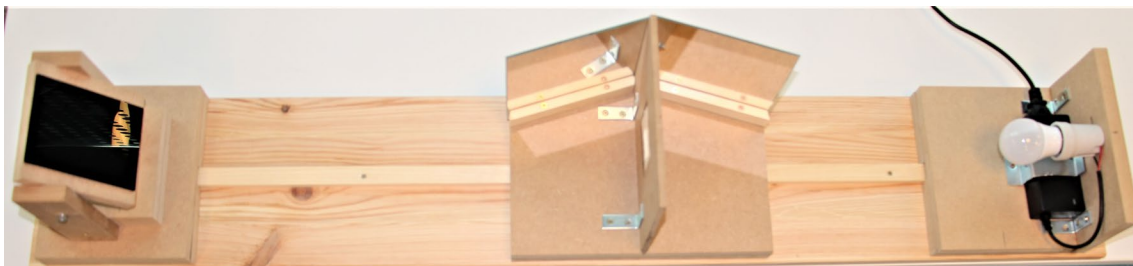
Abbildung 6: Reflektor-Einheiten des Selbstbau-Fettfleckfotometers auf der Schiebeschiene. Als Reflektoren werden hier Schweißglasplatten genutzt, weil diese im Gegensatz zu Spiegeln einen deutlich geringeren Reflexionsgrad (der zur Reduzierung der Strahlstärke der Sonne benötigt wird) haben. Links: Drehbarer Reflektor zum „Einfangen“ des Sonnenlichts (siehe auch Abb. 7). Die Trägerplatte des Reflektors wurde mittels Stuhlwinkeln mit den zwei aufrechten Halteplatten drehbar verschraubt. Rechts: 45°-Spiegel zum Umlenken der Lichtstrahlen (siehe auch Abb. 7). ©: Olaf Fischer.
