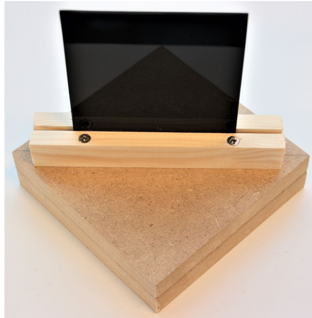
Abbildung 6: Reflektor-Einheiten des Selbstbau-Fettfleckfotometers auf der Schiebeschiene. Als Reflektoren werden hier Schweißglasplatten genutzt, weil diese im Gegensatz zu Spiegeln einen deutlich geringeren Reflexionsgrad (der zur Reduzierung der Strahlstärke der Sonne benötigt wird) haben. Links: Drehbarer Reflektor zum „Einfangen“ des Sonnenlichts (siehe auch Abb. 7). Die Trägerplatte des Reflektors wurde mittels Stuhlwinkeln mit den zwei aufrechten Halteplatten drehbar verschraubt. Rechts: 45°-Spiegel zum Umlenken der Lichtstrahlen (siehe auch Abb. 7). ©: Olaf Fischer.
