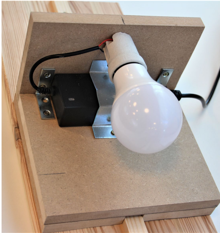
Abbildung 4: Lampen-Einheit des Selbstbau-Fettfleckfotometers auf der Schiebeschiene. Aus Sicherheitsgründen wird mit 12-V-Lampen (nur noch als LED-Lampen erhältlich) gearbeitet. Der notwendige Transformator wurde auf der Lampeneinheit befestigt. Die Porzellanfassung wird an den aufrechten Teil der zuvor mit Stuhlwinkeln zum L verschraubten MDF-Platten mittels Holzschrauben angebracht. ©: Olaf Fischer.
