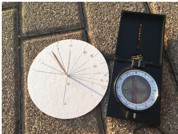
Abbildung 3: Eine ganz einfache Sonnenuhr ist schnell gebaut: ein kleines Loch in die Mitte eines Bierdeckels bohren und einen unten begradigten Zahnstocher hineinstecken. Jetzt jede Stunde den Schatten des Stabes am Rand markieren (Stundenlinie) und beschriften. Ob diese Sonnenuhr aber das ganze Jahr funktioniert? ©: Natalie Fischer, HdA.
