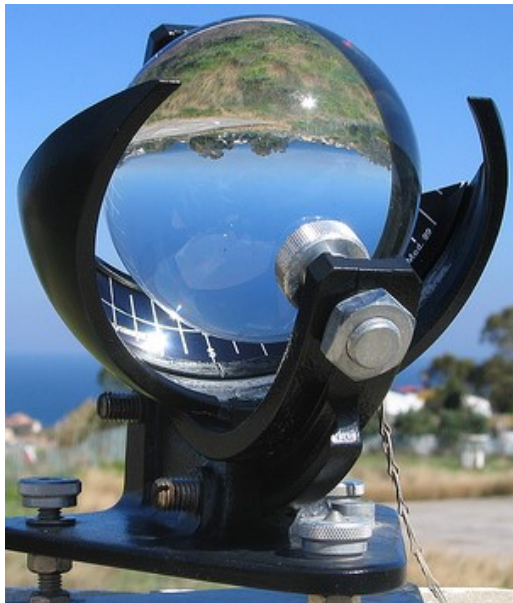
Abbildung 4: Der Sonnenscheinautograph für eine Wetterstation arbeitet als äquatoriale Sonnenuhr. Immer wenn die Sonne scheint, wird auf dem Nachweispapier ein Brennfleck erzeugt. ©: M a Victoria Fernández Arboleya (vfarboleya) - Eigenes Werk, CC BY-SA 3.0, https://commons.wikimedia.org/w/index.php?curid=1222953 .
