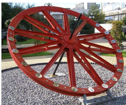
Abbildung 5: Während bei der äquatorialen Sonnenuhr (links, Standort: Berg- und Hüttenakademie Krakau) die Stundenlinien äquidistant ( 15^\circ pro Stunde) verlaufen, sind ihre Winkelabstände bei der horizontalen Sonnenuhr (rechts, Standort: Brasilien) verschieden groß. ©: Von Andrzej Otrębski - Eigenes Werk, CC BY-SA 3.0, https://commons.wikimedia.org/w/index.php?curid=23039079 , FilipCT - Own work, CC0, https://commons.wikimedia.org/w/index.php?curid=21276303 .
