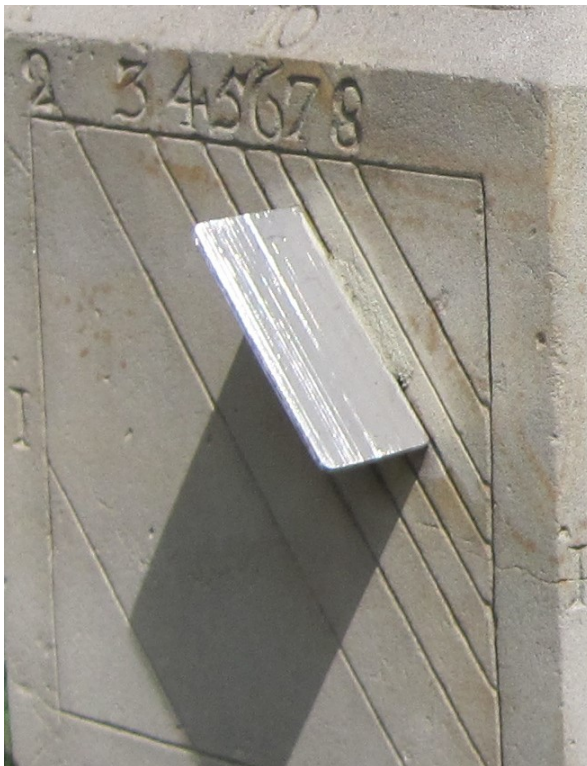
Abbildung 15: Polare Westuhr als Teil der Polyeder-Sonnenuhr des Stadtmuseums Göttingen (rechts). Die polare Westuhr „funktioniert“ am Nachmittag. Im Bild wird eine wahre Ortszeit von 13 Uhr (1) angezeigt. ©: Stefan Flöper / Wikimedia Commons, CC BY-SA 4.0, https://commons.wikimedia.org/w/index.php?curid=20397285 .
