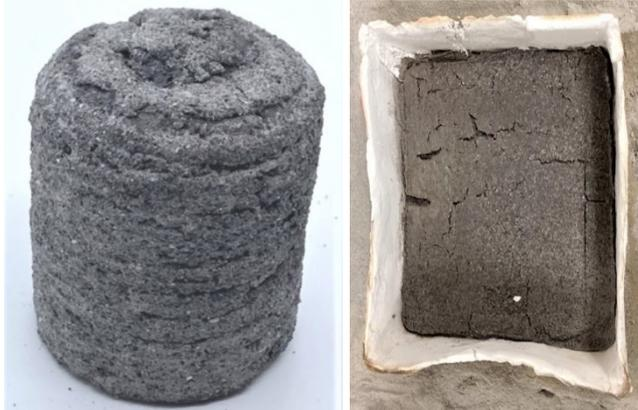
Abbildung 19: Links: Stein, der nach Erstarrung des Regoliths, welches durch einen Laser aufgeschmolzen wurde, entstanden ist. Rechts: "Ziegel", der durch Mikrowellen-Sinterung von Regolith entstanden ist.
