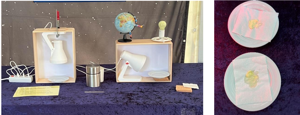
Abbildung 7: Versuchsaufbau im Überblick (linkes Bild) und Ergebnis (rechtes Bild). Trifft das Licht senkrecht auf den Teller, schmilzt dort die Margarine schneller und zieht rascher großflächig in das Papier ein (rechtes Bild Teller unten) als bei schrägem Lichteinfall (rechtes Bild Teller oben). Bilder: Natalie Fischer
