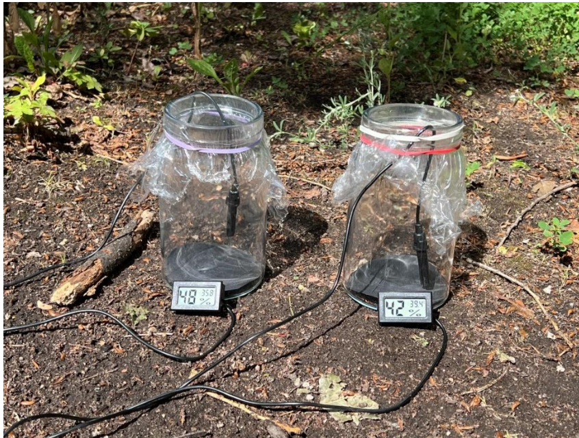
Abbildung 8: Versuchsaufbau im Überblick: Die Thermometer hängen in gleicher Höhe über dem Glasboden. Im rechten Glas befindet sich Kohlendioxid. Die Temperaturen stehen rechts oben: linkes Glas 35,8 Grad, rechtes Glas 39,4 Grad (die großen Ziffern zeigen die relative Luftfeuchtigkeit an). Bild: Natalie Fischer
