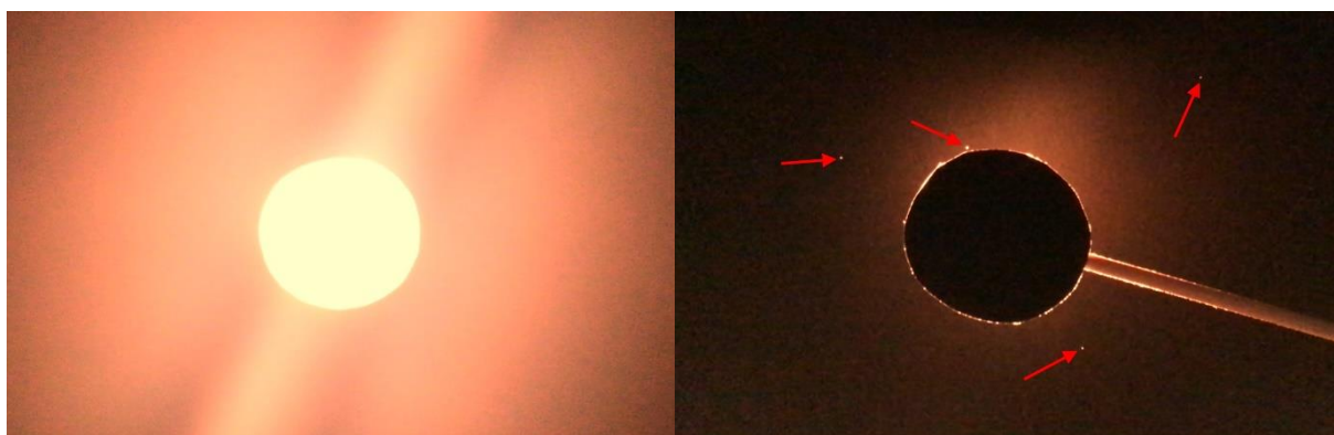
Abb. 4: Versuch zum Prinzip eines Koronographen © Talha Coktasar
