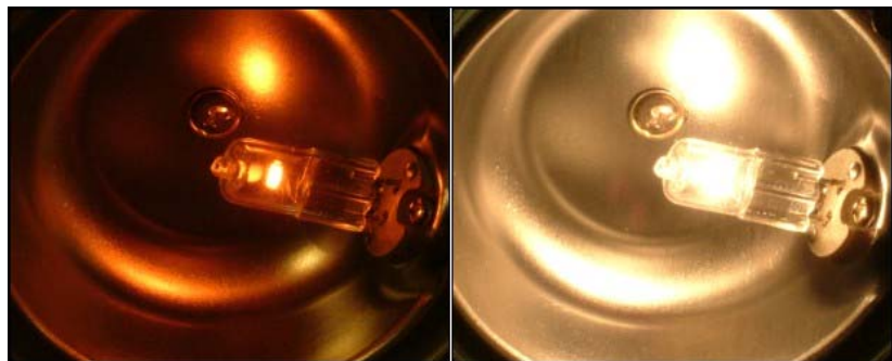
Das Leuchten einer Glühlampe bei 700 °C (links) und 2500 °C (rechts). Deutlich sind die Farbunterschiede der Strahlung zu erkennen.
