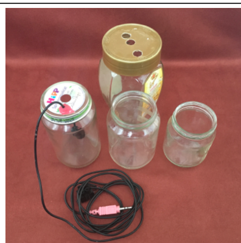
Abbildung 6: Helmholtz-Resonatoren gefertigt aus Hipp- und Honig-Gläsern.
