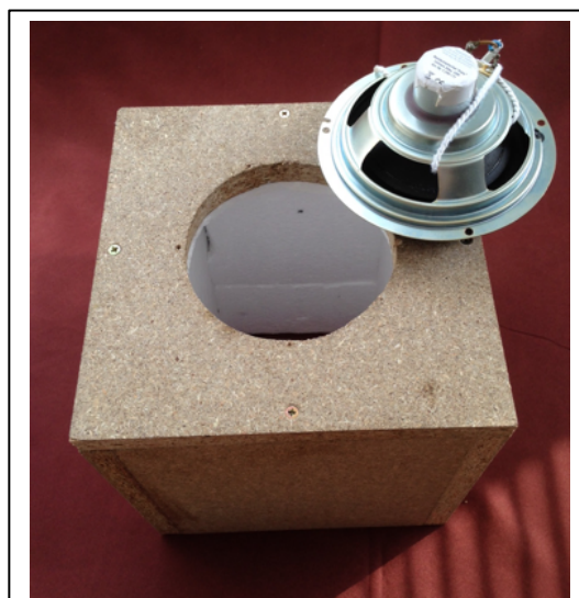
Abbildung 8: Mit Styropor ausgekleidete Box zum Schutz vor Störgeräuschen von außen.
