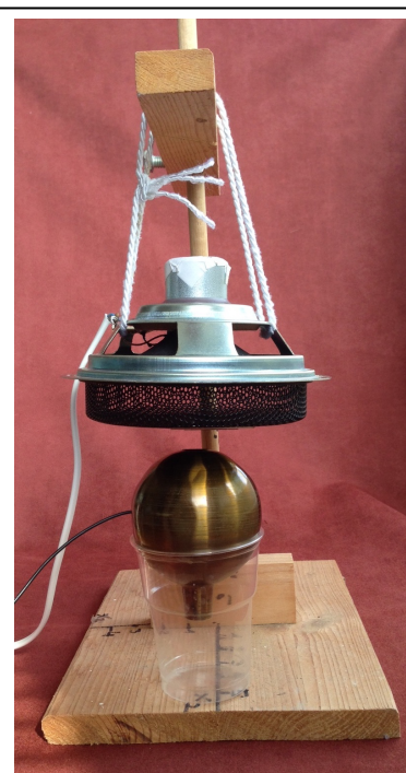
Abbildung 7: Experimenteller Aufbau zur Untersuchung der Helmholtz-Resonatoren.
