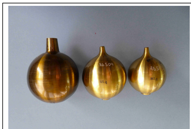
Abbildung 5: Die untersuchten originalen Helmholtz-Resonatoren aus der Sammlung des Physikalischen Instituts der Universität Heidelberg.
