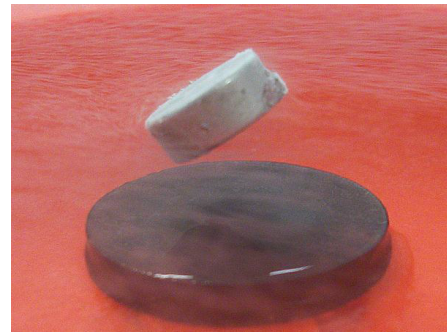
Abbildung 5: Aufnahme des Versuchs zum Meißner-Ochsenfeld Effekt.
