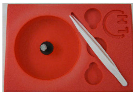
Abbildung 4: Versuchsaufbau zum Meißner-Ochsenfeld-Effekt. In der Schale für den flüssigen Stickstoff befindet sich das schwarze Supraleiter-Pellet, darüber der graue Permanentmagnet. Die Pinzette dient zur Positionierung des Magneten über dem Supraleiter im Stickstoffbad.
