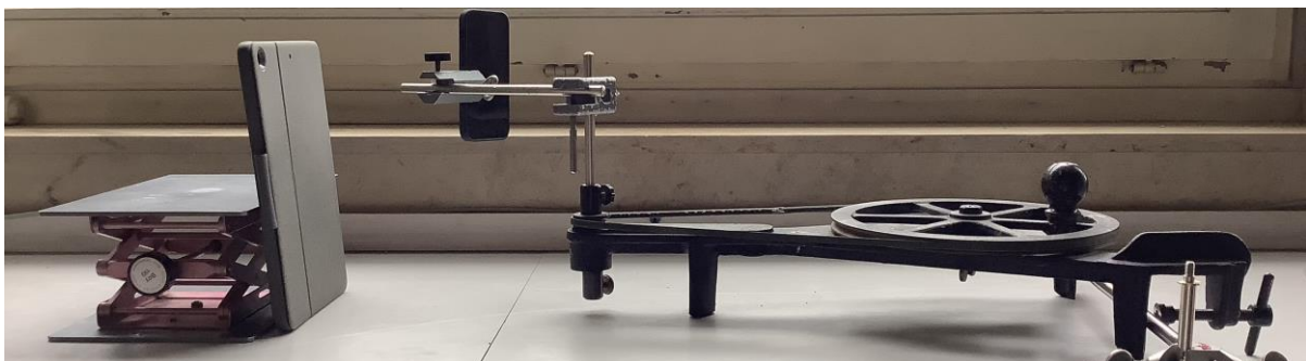
Abbildung 2: Versuchsaufbau zum Versuch „Akustischer Doppler-Effekt“. © Katharina Supp
