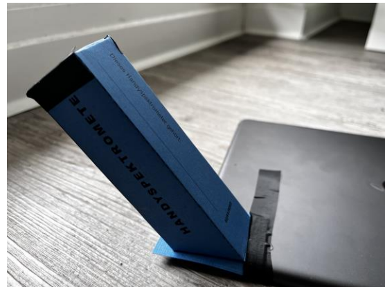
Abbildung 2: Gehäuse des Handyspektrometers und die beiden Rechtecke für den Eintrittsspalt (links), fertiges Spektrometer am Tablet (rechts). © Katharina Supp
