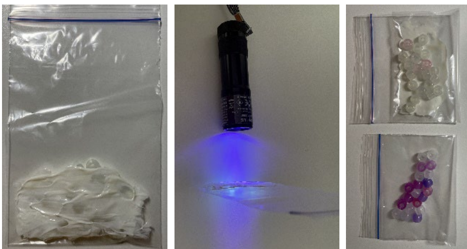
Abbildung 7: Zum Experiment 3.2.4: UV-Perlen hinter Sonnencreme unter UV-Licht (links, Mitte), UV-Perlen mit und ohne Sonnencreme nach Belichtung mit UV-Licht (rechts). © Talha Coktasar.
