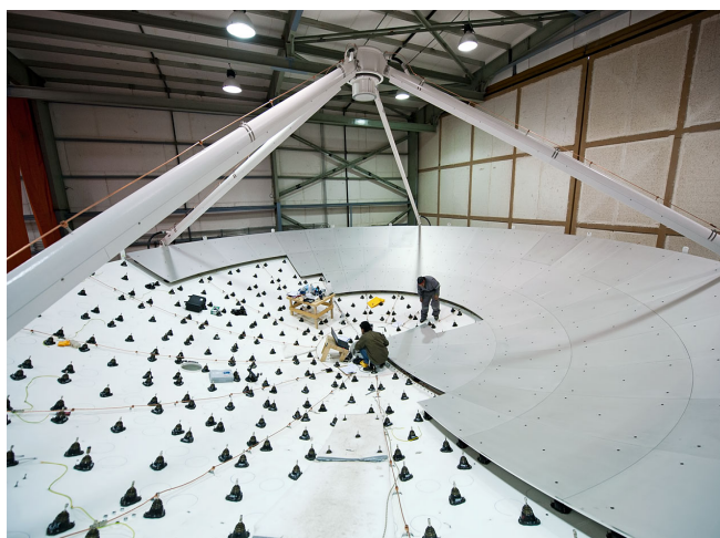
Abbildung 6: Fertigstellung einer ALMA-Schüssel: Die aus einem aus Kohlefaser bestehenden Verbundwerkstoff hergestellte Teleskopschüssel (zusammengesetzt aus 24 Teilen) wird mit metallischen Paneelen (264 Teile) belegt. Die Abweichung vom idealen Paraboloid darf max. 25 Mikrometer betragen. Es wird ersichtlich, dass die Oberfläche nur matt schimmert und nicht glänzt, was auf eine gewollte Rauigkeit gegenüber dem sichtbaren Licht zurückzuführen ist. ©: ESO/José Francisco Salgado, josefrancisco.org. https://cdn.eso.org/images/large/alma-ifs-2010-08.jpg .
